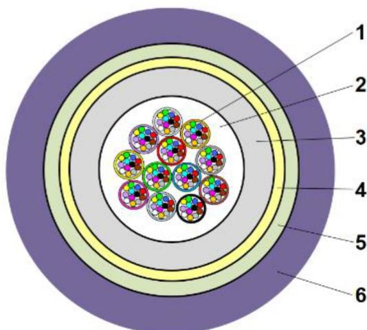
1. "Compact tube" : 6 ou 12 fibres optiques unimodales ou multimodales 50/125 assemblées sous peau thermoplastique "pelable"
